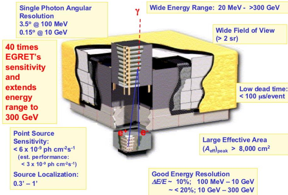
Fig. 2 The GLAST instrument.
